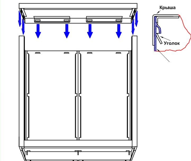
Перед установкой крыши приварные уголки при необходимости отогнуть. Пространство между отгибами при необходимости прочистить от излишков краски. Устанавливать крышу равномерно, до характерного щелчка. (двери на рис. не показаны)
