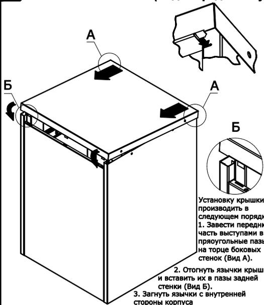
Установку крышки производить в следующем порядке:
