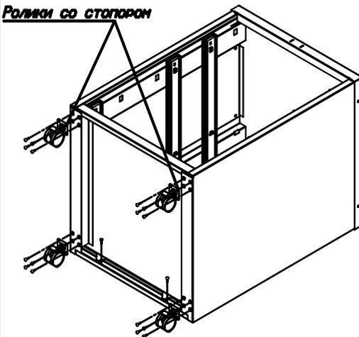
Закрепить заднюю стенку на основании при помощи двух винтов и закрепить ролики на нижней части тумбы, так как это показано на рисунке, при этом ролики со стопорами необходимо разместить с лицевой стороны тумбы.
